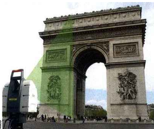
A l'extérieur et l'intérieur, le scanner 3D balaye les parois de l'Arc de Triomphe avec un faisceau laser, enregistrant des millions de points qui donnent un rendu très précis des volumes de l'ouvrage.
